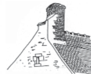
Cheminée en briques dont la souche est encastree au nu extérieur du pignon : solution fréquente dans le Loiret.
